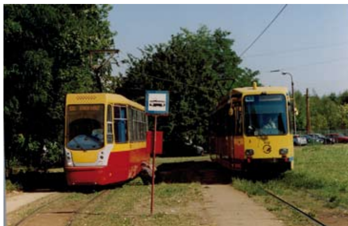
Fot. 22. Testy M8S i rozpoczynający jazdy próbne wagon 805Na ze zmodernizowaną ścianą czołową i aparaturą na prąd zmienny ZEP Enika na pętli Radiostacja (7.09.2005 r.)
