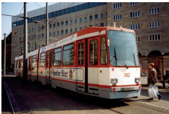
Fot. 5. Norymberski N8S-NF powstały po dodaniu w 1992 r. środkowego modułu niskopodłogowego do wagonu typu N6S; podobne rozwiązanie wprowadzono kilka lat później w tramwajach w Muelheim (1.05.1999 r.) Fot. Stefan von Mach
