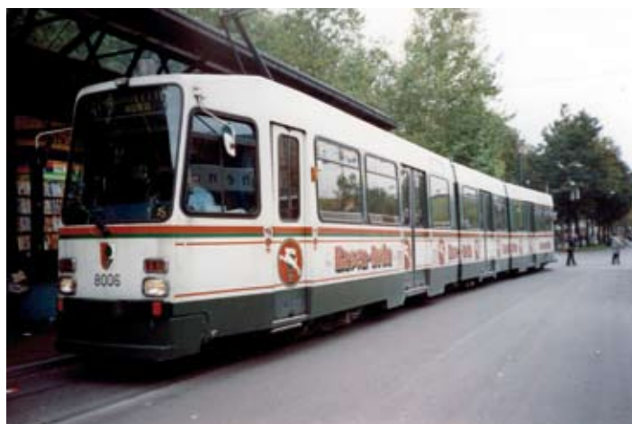
Fot. 3. Tramwaje M8C wyprodukowane w połowie lat 80. XX w. dla Augsburga charakteryzują się dodatkową parą drzwi w środkowym module (16.10.1998 r.) Fot. Stefan von Mach
