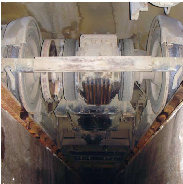
Fot. 12. Wózek napędowy wagonu M8S widziany od spodu; uwagę zwraca ogromny silnik, dobrze widoczne są również obie przekładnie, hamulce szynowe oraz dysze piasecznic przy kołach
