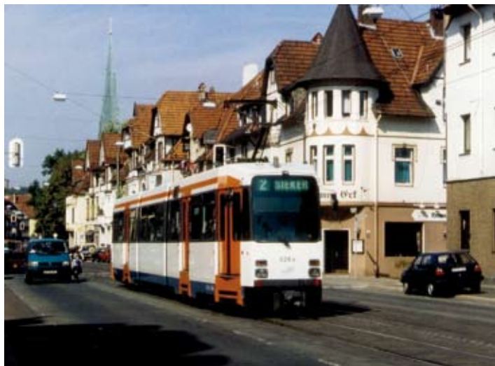
Fot. 4. Wagon M8C w Bielefeld z wejściami przystosowanymi do wysokich peronów (12.09.1999 r.) Fot. Stefan von Mach
