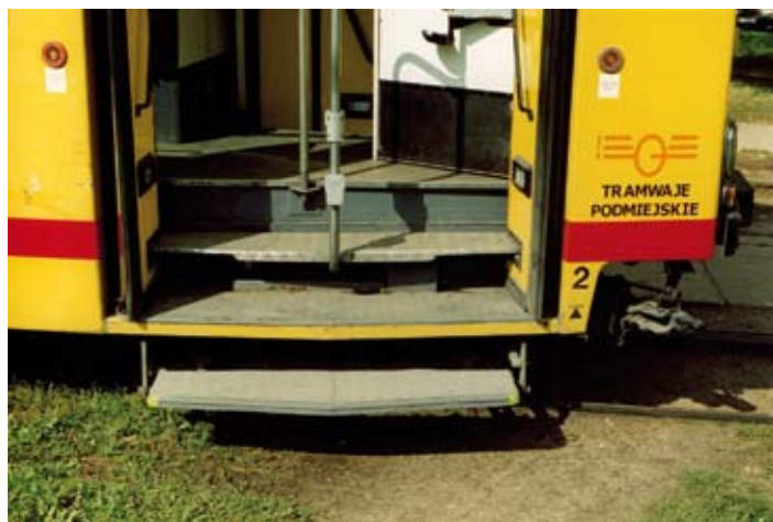
Fot. 14. Wysuwany stopień bardzo ułatwia wsiadanie
