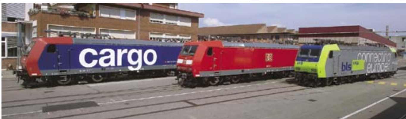
Rys. 2. Przykłady trakcji transgranicznej; u góry po lewej – pociąg z transportem glinki z Limburga (Niemcy) do Domodossola (Włochy); u góry po prawej – połączenie towarowe między Mannheimem (Niemcy) a Metz (Francja); na dole – lokomotywy relacji Niemcy – Szwajcaria: Railion BR 185, SBB Re 482 i BLS Re 485 są identyczne w każdej części
