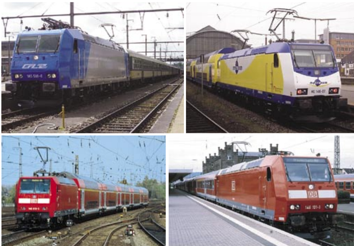
Rys. 4. Lokomotywy platformowe TRAXX stosowane są w pociągach typu „push-pull” z wagonami piętrowymi i jednopoziomowymi
