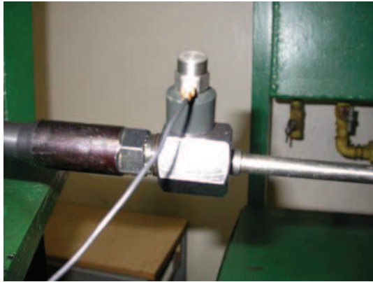
Rys. 2. Przykład mocowania czujnika na przewodzie wysokiego ciśnienia za pomocą magnesu
