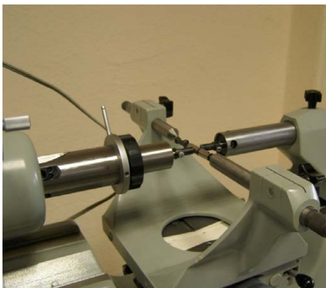
Rys. 6. Schemat pomiarów i stanowisko pomiarowe średnicy zewnętrznej elementu tłoczącego na części prowadzącej; 1, 2 – nr pomiaru; A-A, B-B – kierunki pomiaru
