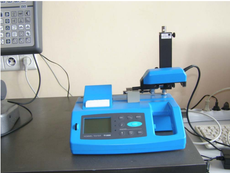
Rys. 7. Stanowisko do pomiaru chropowatości powierzchni elementu tłoczącego (przyrząd Hommel Tester T1000)
