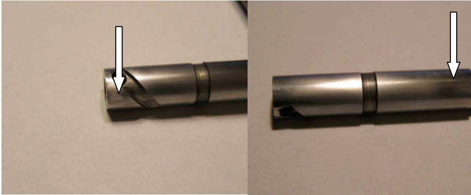
Rys. 1. Przykłady uszkodzonych powierzchni elementu tłoczącego (strzałkami zaznaczono miejsca widocznych uszkodzeń zużyciowych)
