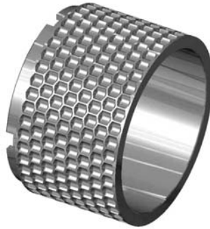
Rys. 1. Pierścień formujący brykietciarki walcowej z wgłębieniami (półformami) do otrzymywania brykietów w kształcie poduszki, czyli z płaszczyzną podziału
