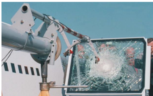
Rys. 1. Przeprowadzony test szyby przedniej do autobusu szynowego na stanowisku prób dynamicznych Instytutu Lotnictwa Źródło (fot. Archiwum ILOT)
