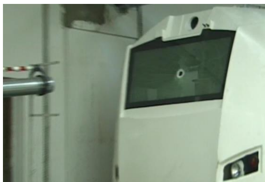
Rys. 6. Przebita szyba czołowa pojazdu szynowego (foto -[8]).
