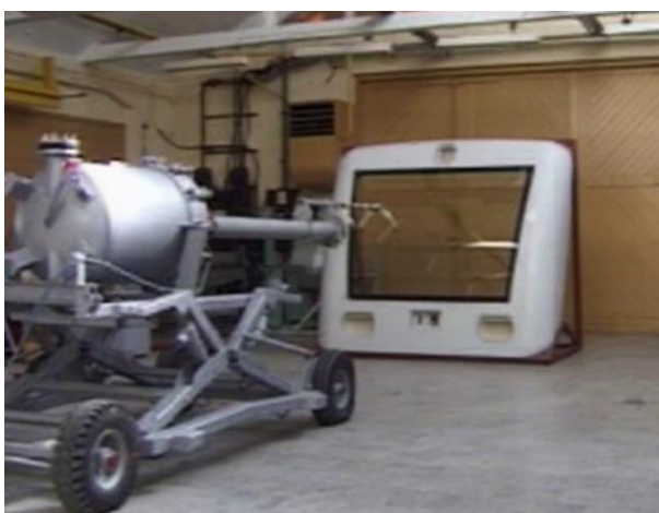
Rys. 2. Ostateczny test szyby przedniej do autobusu szynowego na stanowisku prób dynamicznych Instytutu Lotnictwa Źródło (fot. Archiwum ILOT)
