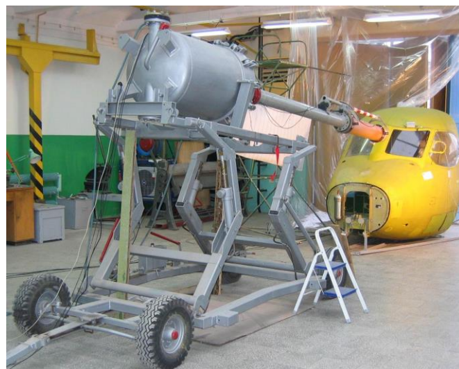
Rys. 3. Przygotowane stanowisko do przeprowadzenia testu oszklenia kabiny samolotu na przebicie - Instytut Lotnictwa Źródło (fot. Archiwum ILOT)
