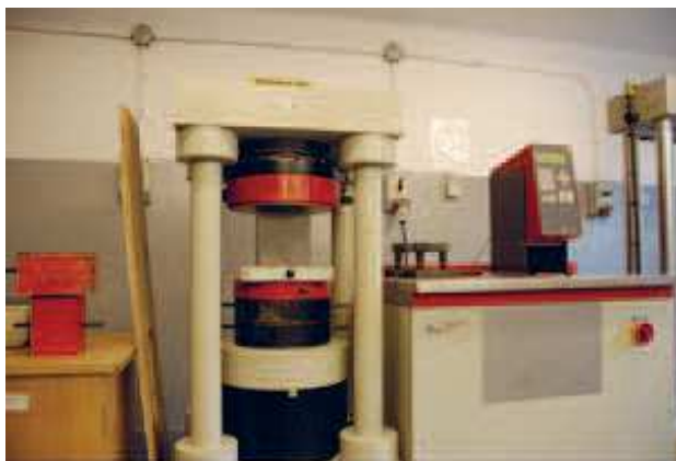
Rys. 2. Stanowisko do badania wytrzymałości na ściskanie betonu
