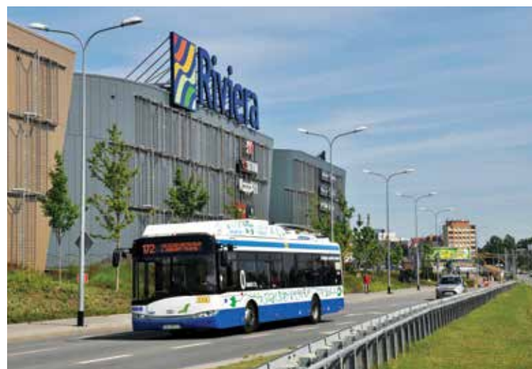
Trolejbus Solaris Trollino 12 w Gdyni wykonujący kurs na linii autobusowej 172 dzięki zasilaniu z zasobnika bateryjnego. Fot. K. Grzonka
