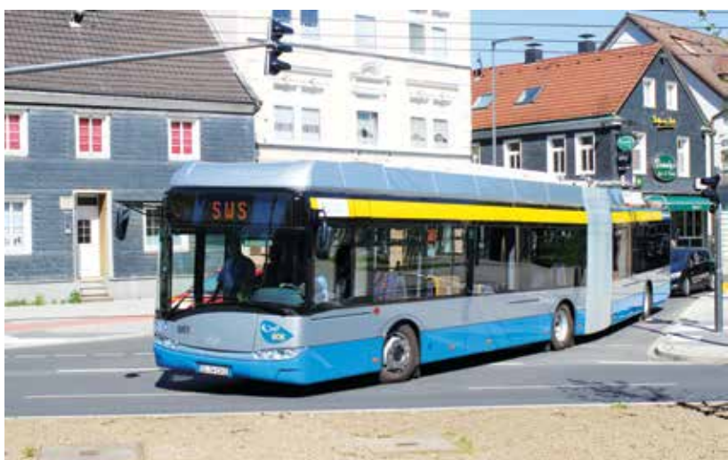
Trolejbus Solaris Trollino 18,75 (tzw. BOB – Batterie-Oberleitungs-Bus) w Solingen wyposażony w baterie litowo-jonowe. Fot. J. Lehmann
