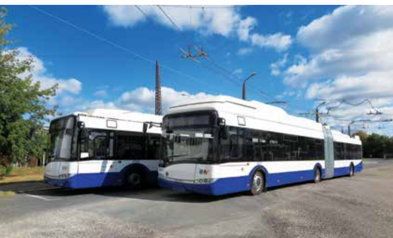
Trolejbusy Solaris Trollino 18 wyposażone w zasobnik wodorowy. Fot. A. Grigorjews
