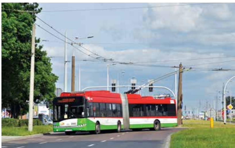
Trolejbus Solaris Trollino 18 w Lublinie wyposażony w baterie litowo-jonowe. Fot. K. Grzonka
