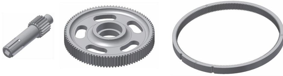
Rys. 2.6. Otrzymane modele bryłowe kół zębatych przekładni planetarnej Fig. 2.6. Finished solid models of gear wheels of the planetary gear
