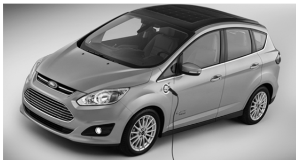
Rys.5. Elektryczny samochód Ford z panelami fotowoltaicznymi na dachu
