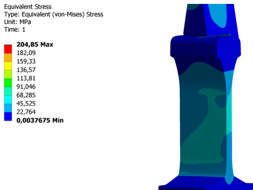
Rys. 6. Stan naprężeń zredukowanych dla przypadku kontaktu koła z szyną
