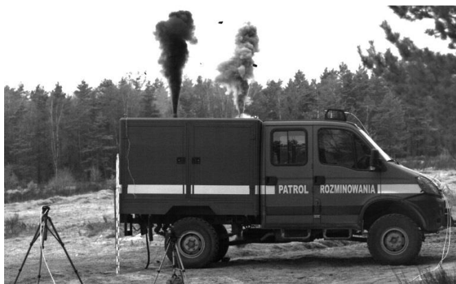
Fot. 7. Próba detonacji pocisku odłamkowo-burzącego typu OF412 o ekwiwalencji 3,5kg czystego TNT w pojemniku przeciwdziałkowym typu zamkniętego, wentylowanego prototypu samochodu „Topola-S”. Widoczna początkowa faza detonacji z zatrzymaniem odłamków w pojemniku i uwolnieniem gazów powstałych w czasie detonacji
