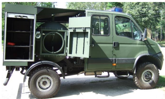
Fot. 3. Pierwszy prototyp pojazdu saperskiego „Topola-S”. Widoczne położenie pojemnika przeciwołdławkowego do przewożenia niewybuchów i niewypałów o ekwiwalencie do 3,5 kg czystego TNT i pierwotnie zastosowana konstrukcja zamknięcia pojemnika z deflektorem gazów powybuchowych
