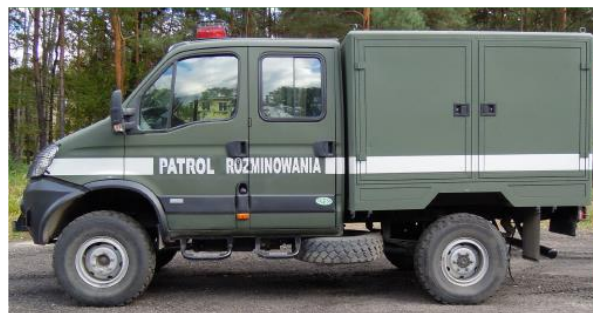
Fot. 1. Prototyp pojazdu saperского „Topola-S” w wersji przeznaczonej do produkcji seryjnej z pojemnikiem przeciwodłamkowym do przewożenia niewybuchów i niewypałów o ekwiwalencie do 3,5 kg czystego TNT. Widoczna kabina pasażerska dla 6-cio osobowej załogi i zwarta zabudowa przeznaczona na kompletne wyposażenie patrolu rozminowania
