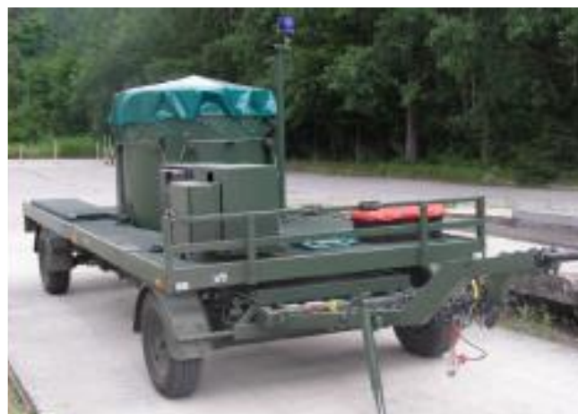
Fot. 4. Pierwszy prototyp przyczepy „Topola-P”. Widoczny centralnie umieszczony pojemnik przeciwołdławkowy do przewożenia niewybuchów i niewypałów o ekwiwalencie do 10 kg czystego TNT
