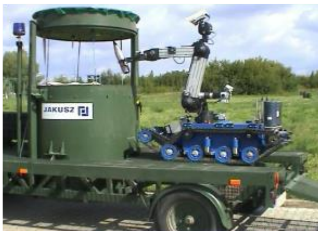
Fot. 5. Pierwszy prototyp przyczepy „Topola-P”. Widoczne próby zdalnego załadunku makiety pocisku do pojemnika przeciwołamkowego
