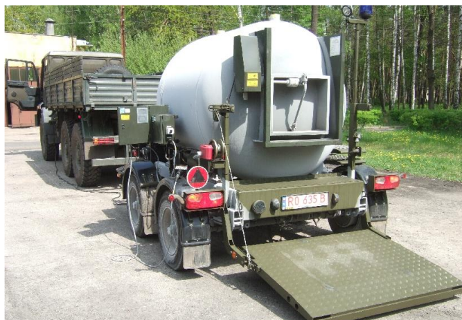
Fot. 2. Prototyp przyczepy „Topola-P” w wersji przeznaczonej do produkcji seryjnej. Widoczny pojemnik przeciwołdławkowy do przewożenia niewybuchów i niewypałów o ekwiwalencie do 10 kg czystego TNT oraz rozkładany pomost przeznaczony do prac z wykorzystaniem możliwości zdalnego załadunku i wyładunku przedmiotów z użyciem robota saperskiego
