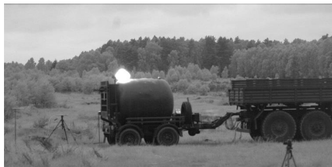
Fot. 8. Próba detonacji pocisku odłamkowo-burzącego typu OF540 o ekwiwalencji 10kg czystego TNT w pojemniku przeciwdziałkowym typu zamkniętego, wentylowanego prototypu przyczepy „Topola-P”. Widoczna początkowa faza uwolnienia gazów powstałych w czasie detonacji i odkształcenia pojemnika przez odłamki
