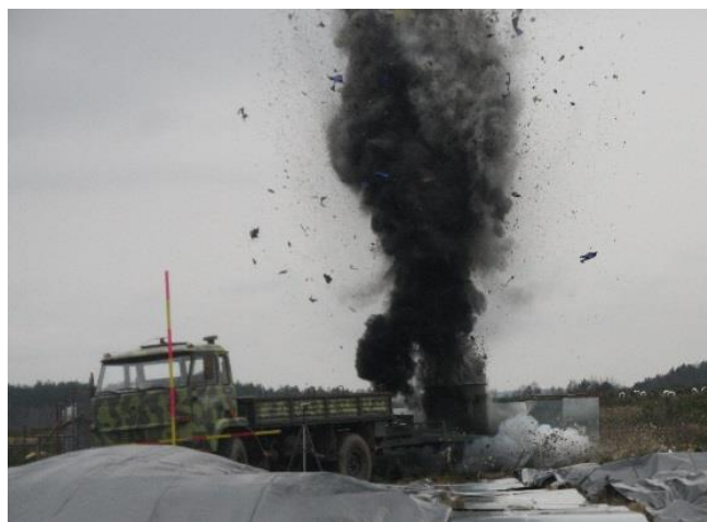
Fot. 6. Próba detonacji pocisku odłamkowo-burzącego typu OF540 o ekwiwalencie 10kg czystego TNT w pojemniku przeciwołamkowym typu otwartego pierwszego prototypu przyczepy „Topola-P”. Widoczny efekt ukierunkowanego wylotu odłamków do góry i pod przyczepę i brak wylotu na bok przez konstrukcję walca
