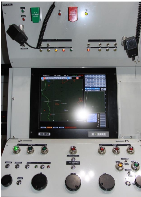
Rys. 1. Stanowisko Oficera Strzelającego w Kabinie Dowodzenia i Naprowadzania przeciwlotniczego zestawu rakietowego
