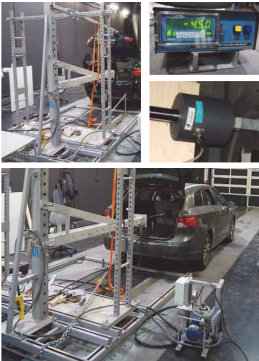
Fot. 4. Urządzenie do badania przegrody w samochodzie z przestrzenią ładunkową
