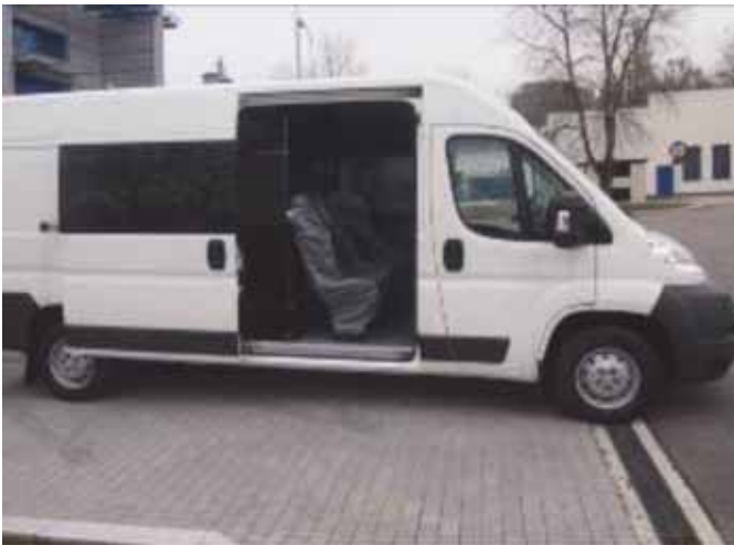
Fot. 7. Przykład samochodu ciężarowego ze zmienioną przegrodą w części ładunkowej i dodatkowym rzędem foteli
