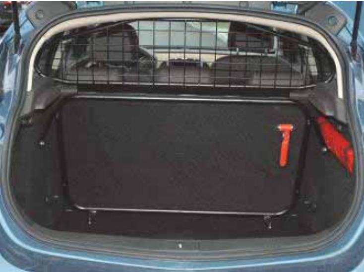
Fot. 2. Przestrzeń ładunkowa oddzielona od pasażerskiej za pomocą przegrody zamocowanej zgodnie z Normą ISO 27956-2009
