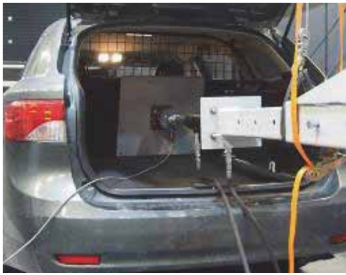
Fot. 6. Przykład umiejscowienia stempla "średniego" (z racji ograniczeń rozległości przegrody w części ładunkowej) w samochodzie poddawany testom wytrzymałościowym.
