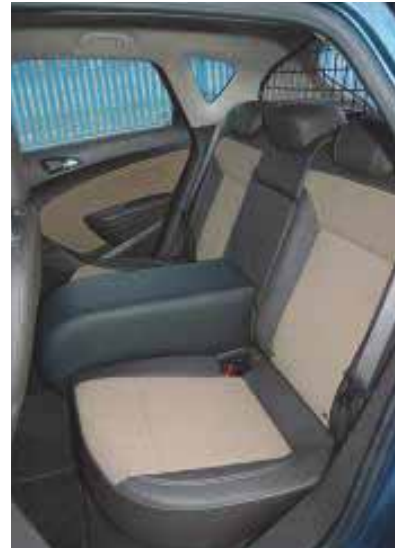
Fot. 3. Montaż podłokietnika eliminującego środkowe miejsce pasażera zwiększającego przewagę masy ładunku nad masą przewożonych osób
