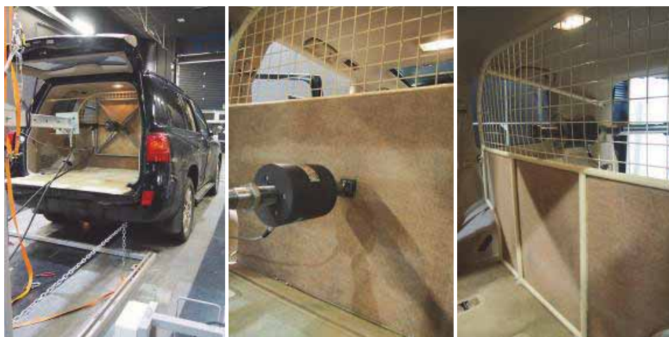
Fot. 5. Przykład umiejscowienia stempla "dużego" i "małego" wraz z aparaturą pomiarową w samochodzie poddawany testom wytrzymałościowym po dokonaniu zmiany przegrody w części ładunkowej
