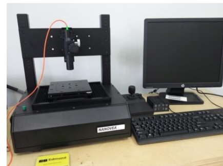
Rys. 2. Stanowisko badawcze – profilometr Nanovea PS50
