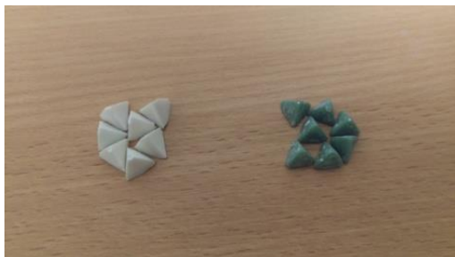
Rys. 10. Przykłady wkładek do wygładzarek bębnowych
