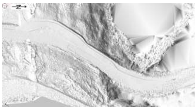
Rys. 4.2. Numeryczny model najbardziej zagrożonego odcinka DW 981 otrzymany z pomiarów w dniu 18.12.2015 r.
