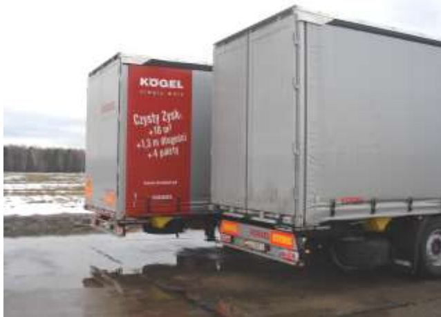
Rys. 4. Naczepa o normalnej wartości długości i naczepa wydłużona o wartość 1,3m
