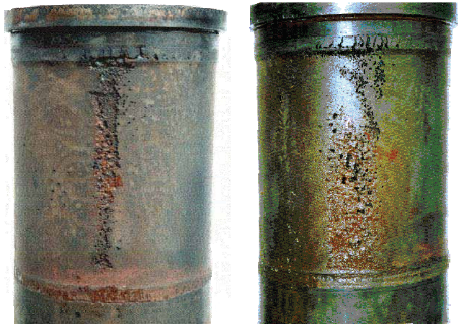
Rys. 1. Uszkodzone przez erozję kawitacyjną mokre tuleje cylindrowe silnika 359M [2]
