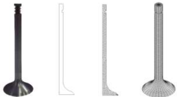
Rys. 3. Kolejne etapy tworzenia modelu geometrycznego zaworu wylotowego silnika
