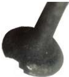
Rys. 1. Przykładowe uszkodzenie zaworu
