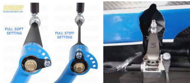
Rys. 5. Zmiana sztywności ramion; mechaniczna; elektroniczna [7]
