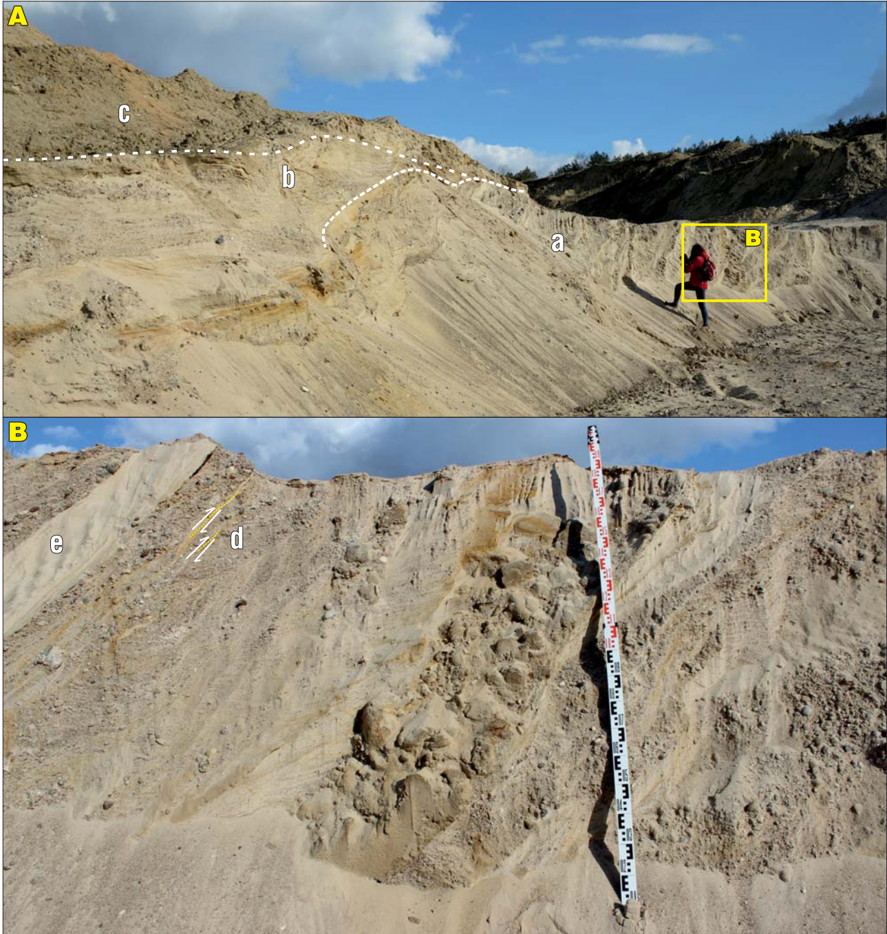
Ryc. 6. Stanowisko Kotliny 1. Kontakt osadów podłoża rynny Miazgi–Wolbórki (jednostka C) z osadami wypełniającymi rynnę. Ściana odsłonięcia o azymucie ok. 170–180°; miarka długości 2 m: a – monoklinalnie wychylone osady glaciofluwialne jednostki C, starsze od zlodowacenia warty, b – glaciofluwialne piaski ze żwirem wypełniające rynnę (jednostka E), c – hałda, d – ślady nasunięć (uskoki odwrócone), e – asymetryczne fałdy w litofacji piaszczystej
