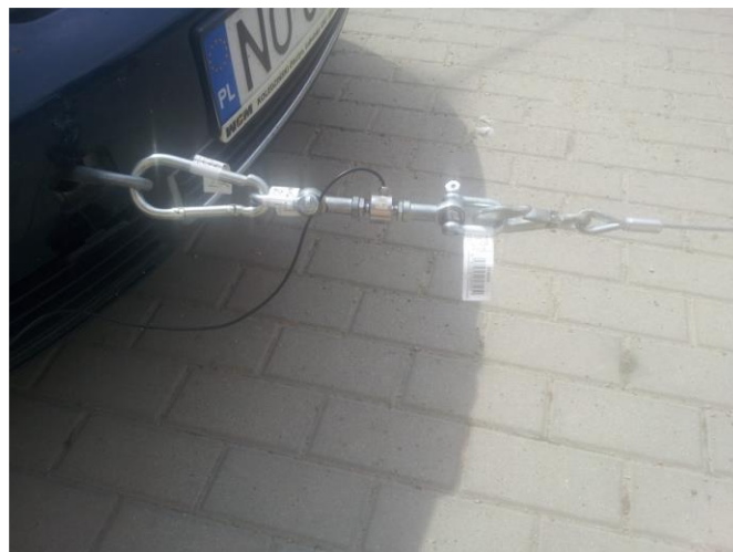
Rys. 2. Czujnik siły FT-3507 zamontowany do przetaczanego pojazdu
