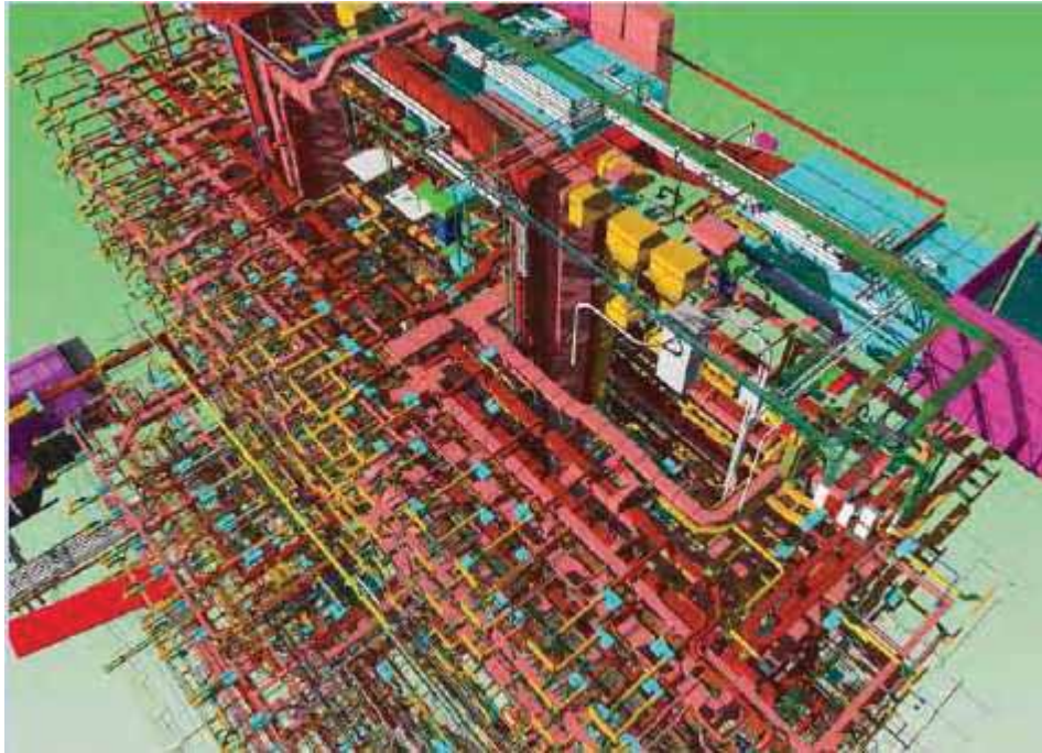
Rys. 2. Elementy instalacyjne modelu BIM dla przykładowego budynku [4]
