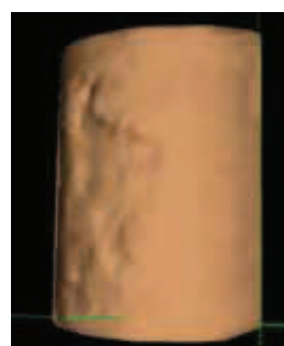
Rys. 6. Model 3D uszkodzonej kolumny
