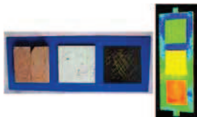
Rys. 1. Przykłady badanych próbek (cegła, drewno i szkło witrażowe) i ich skan
