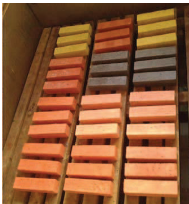
Rys. 1. Próbkę dojrzewające w komorze klimatycznej
