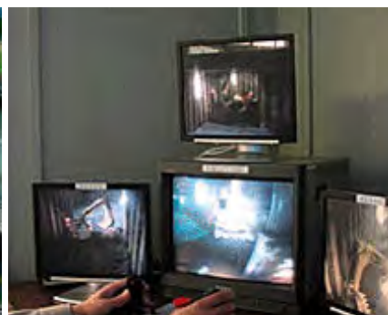
Rys. 5. Zdalne sterowanie maszynami budowlanymi; a) zdalnie sterowany robot firmy Fujita [25], b) centrum sterowania maszynami – Penta-Ocean Construction Co. [26]
