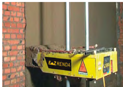
Rys. 3. Robot tynkarski firmy EZ-Renda [23]
