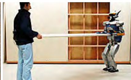
Rys. 4. Montaż paneli z wykorzystaniem humanoidalnego robota HRP-2 "Promet" firmy Kawada Industries, Inc. [24]
