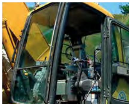
Rys. 5. Zdalne sterowanie maszynami budowlanymi; a) zdalnie sterowany robot firmy Fujita [25], b) centrum sterowania maszynami – Penta-Ocean Construction Co. [26]
