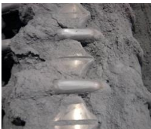
Rys. 2. Widok kół łańcuchowych w trakcie testów zużyciowych w obecności ścierniwa kwarcowego.
