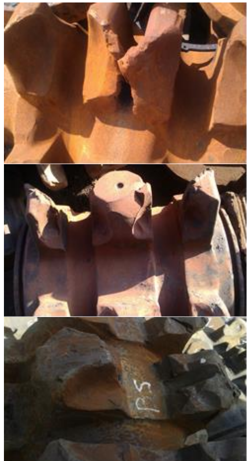
Rys. 1. Przykłady kół łańcuchowych uszkodzonych zużyciem ściernym intensyfikowanym obecnością ścierniwa
