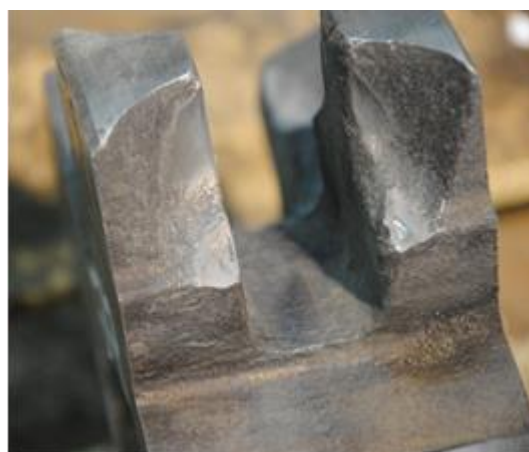
Rys. 3. Widok stref kontaktu łańcucha z kołem łańcuchowym bezpośrednio po testach zużyciowych
