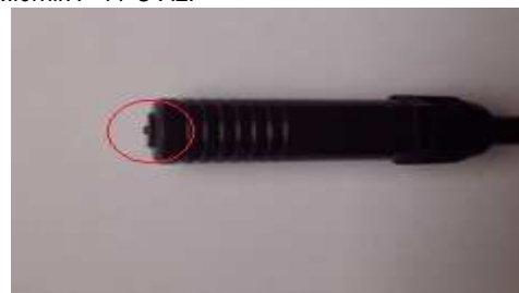
Rys. 5. Sprężyste zawieszona sonda z kulką
