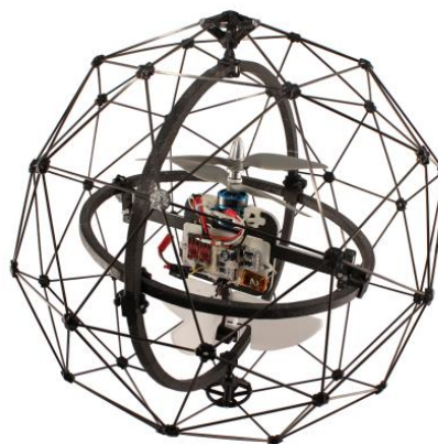
Rys. 7. Bezzałogowy statek powietrzny Gimball do akcji poszukiwawczo-ratowniczych w jaskiniach [12]
