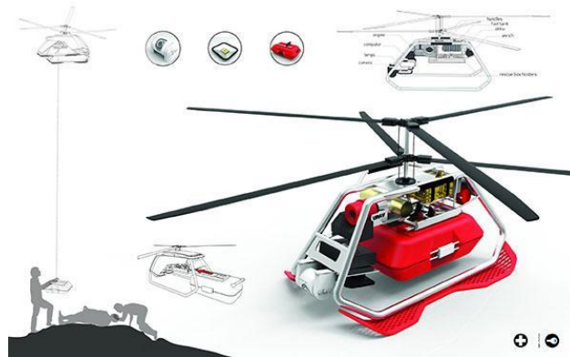
Rys. 8. Projekt drona ratowniczego dla GOPR-u [13]
