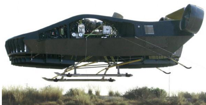
Rys. 9. Bezzałogowy statek powietrzny AirMule stosowany do przewozu rannych z pola walki[14]
