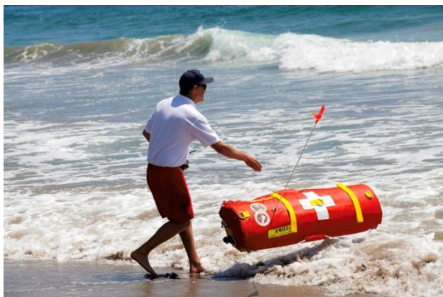
Rys. 12. Zdalnie sterowana łódź ratownicza Emily [16]
