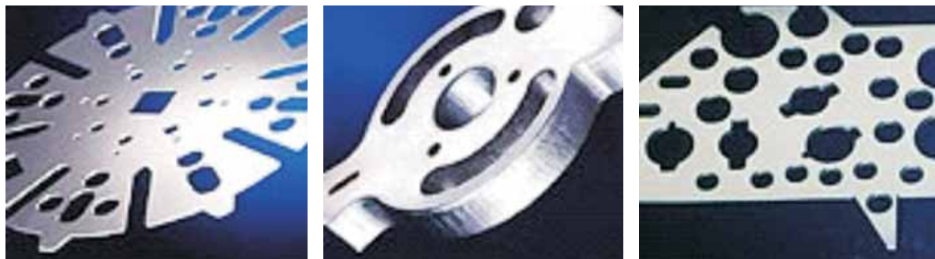
Rys. 1. Przykładowe części uzyskane w procesie wykrawania o charakterystyce krzywoliniowej
