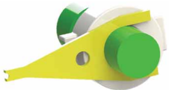
Rys. 6. Model mechanizmu wyciskowego mechanizmu sprzęgła wykonany w programie Solid Works
