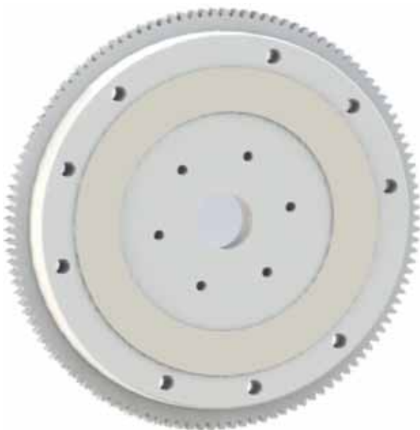
Rys. 5. Model koła zamachowego mechanizmu sprzęgła wykonany w programie Solid Works
