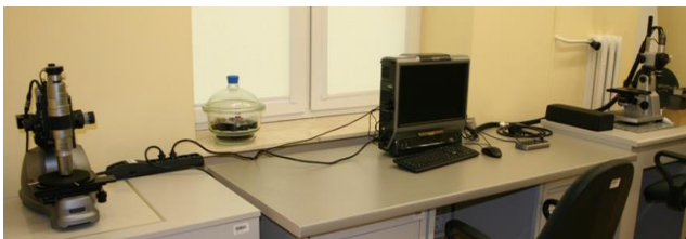
Rys. 2. Mikroskop optyczny Keyence VHX-1000 ze światłowodową transmisją obrazu
