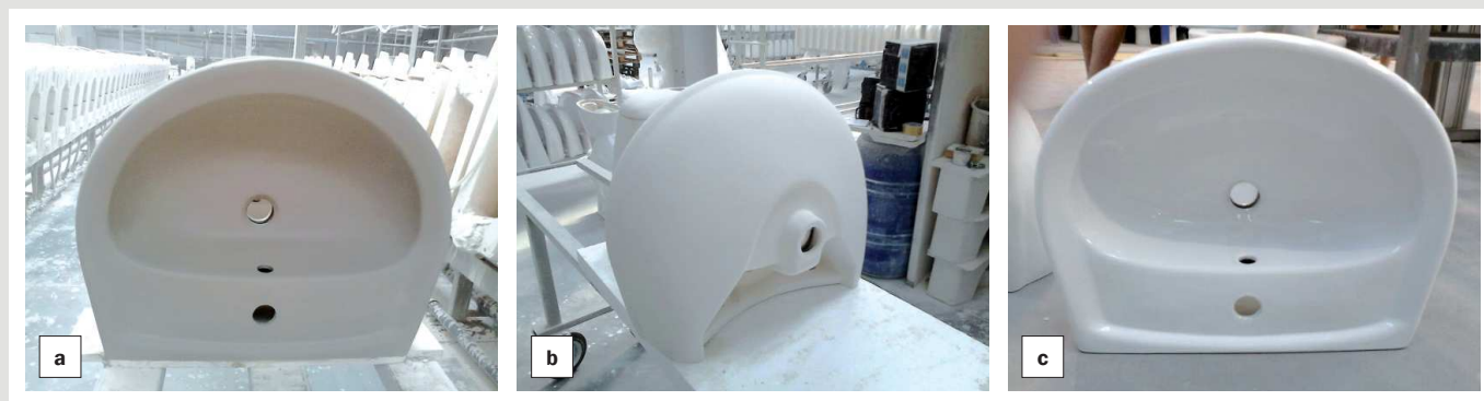
Rys. 7. Wyrób z masy 4: a) po wyjęciu z formy, b) poszkliwiony i c) wypalony w temperaturze 1200 °C
