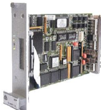
Rys. 3. Widok procesora modułowego stosowanego na poziomie zarządzania w sygnalizacji przejazdowej typu BUES 2000 [4]
