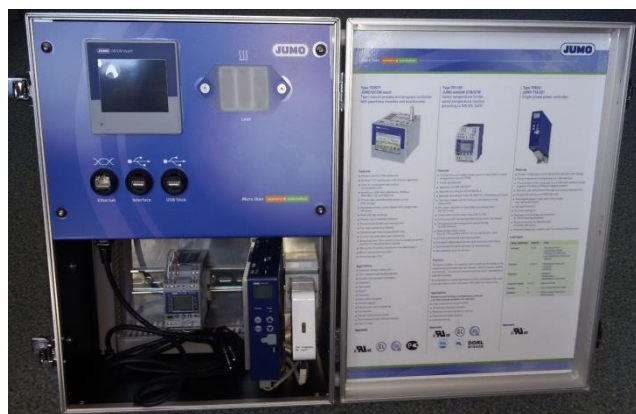
Rys. 1. Widok stanowiska laboratoryjnego do badania właściwości dynamicznych układów sterowania [opracowanie własne]
