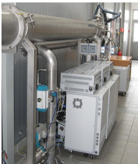
Zdjęcie 2. Laboratorium Badania Emisji Spalin w Instytucie Badań i Rozwoju Motoryzacji BOSMAL – tunel rozcieńczający spaliny
