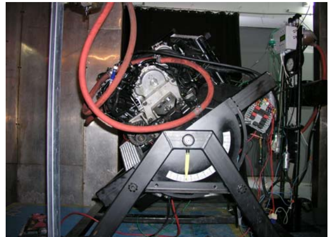
Rys. 2. Silnik na specjalnym stanowisku badawczym przechylony w osi X o kąt -35°.
