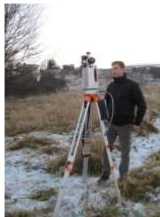
Rys. 3. Pomiary naziemnym skanerem laserowym RIEGL VZ-400 (fot. E. Pilecka)
