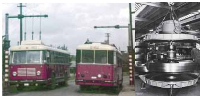
Rys. 1. Autobusy komunikacji miejskiej MFO napędzane energią zgromadzoną w kole zamachowym oraz widok koła zamachowego wraz z moto-prądnicą [2]
