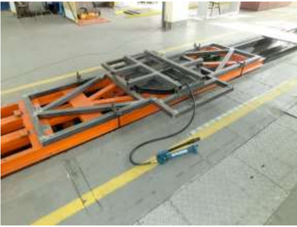
Rys. 12. Zespół obrotnicy zamontowany na wózku badawczym - ustawiony w kierunku wzdłużnym
