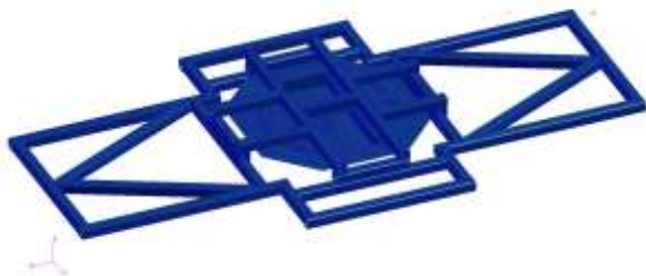
Rys. 6. Model MES stanowiska - obrotnicy (widok od góry)
