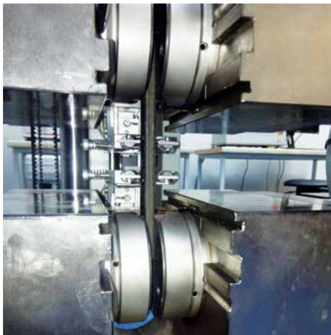
Fot. 3. Badanie wytrzymałości na rozciąganie i modułu sprężystości przewodów trakcyjnych Djp 100
