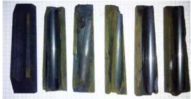
Fot. 4. Nowa (pierwsza od lewej) i zużyte wkładki ślizgowe głowicy troleja
