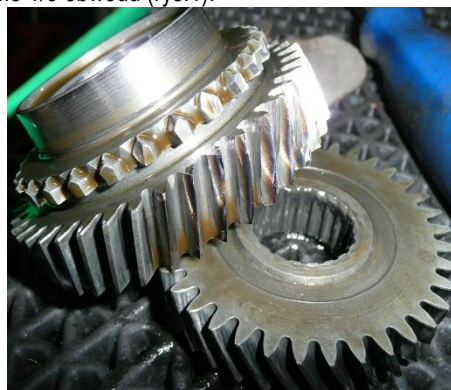
Rys. 1. Zużyta para kół zębatych skrzyni biegów
