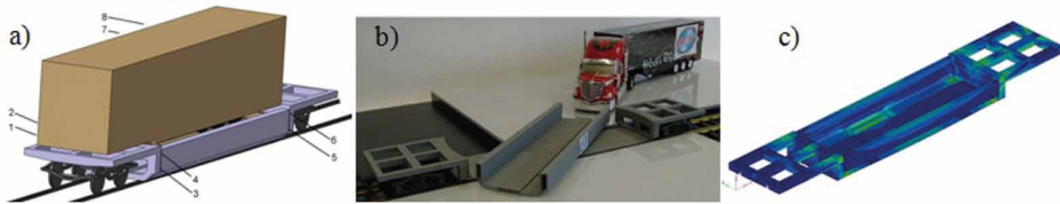
Rys. 2. Schemat wagonu według koncepcji po etapie wstępnych prac projektowych: a) rozmieszczenie punktów 1-8 połączenia pomiędzy ramą wagonu i platformy obrotowej; b) demonstrator zestawu w skali 1:22 wagonu platformy, ciągnika siodłowego z naczepą oraz element infrastruktury peronu; c) przykład wyników badań numerycznych w postaci mapy naprężeń zredukowanych ramy wagonu w niniejszym rozwiązaniu konstrukcyjnym
