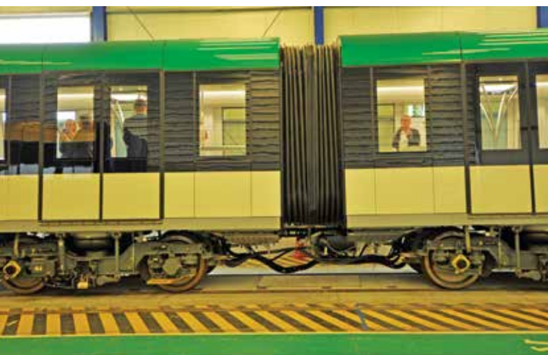
Połączenie międzywagonowe w pociągu Metropolis
