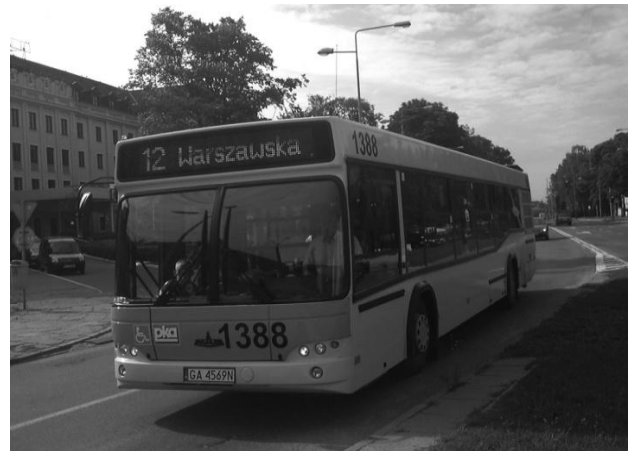
Rys. 3. Niskowejściowy autobus miejski MAZ 103 (PKA Elbląg)
