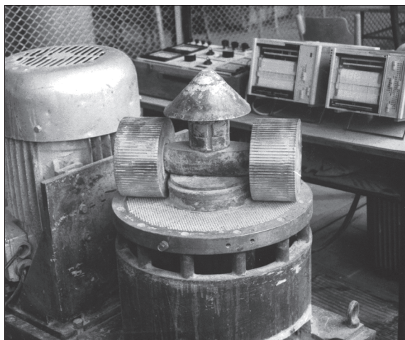
Rys. 1. Układ roboczy urządzenia brykietująco-granulującego z płaską nieruchomą matrycą wraz z rolkami zagęszczającymi [Hejft, 2002]
