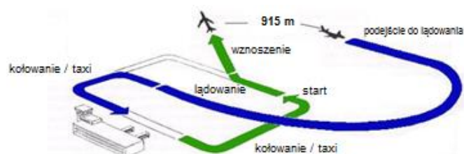
Rys. 4. Etapy operacji samolotu na lotnisku (LTO) [8]
