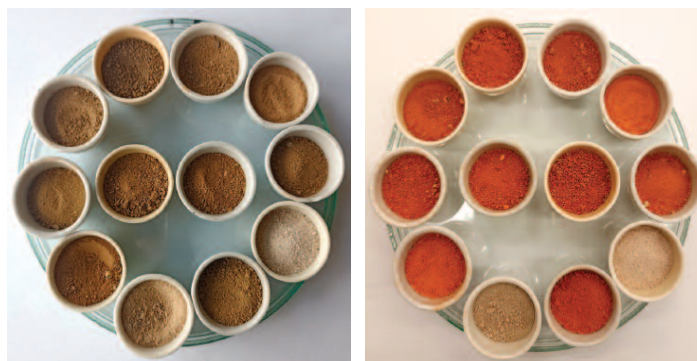
Photo 2. Color change of samples after heating at temperature 440°C Fot. 2. Zmiana barwy próbek po wyprażeniu w temperaturze 440°C
