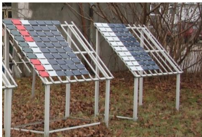
Rys. 1. Starzenie powłok epoksydowych na stacji klimatycznej (usytuowanej na terenie Instytutu Eksploatacji Pojazdów i Maszyn, UTH w Radomiu)
