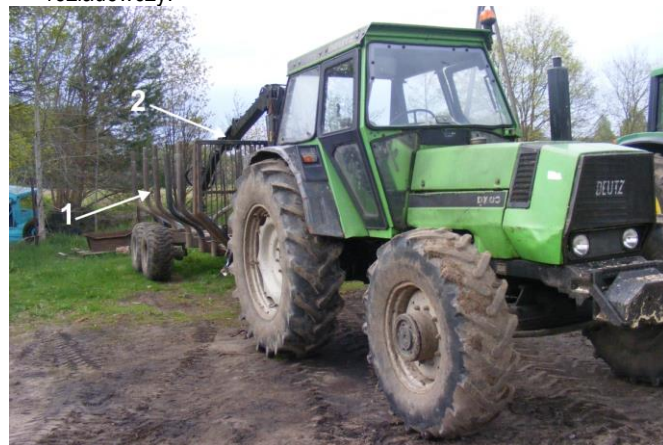
Rys. 2. Zestaw do transportu drewna: ciągnik rolniczy 4x4 oraz przyczepa samozaładowcza (1) z dźwigiem (2)
