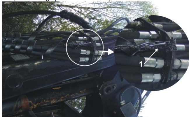
Rys. 7. Wiązka przewodów hydraulicznych podtrzymywana łańcuchem (1)
