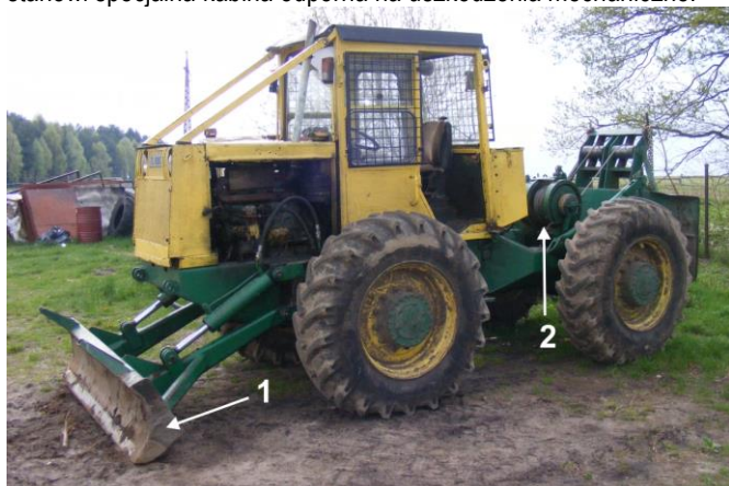
Rys. 3. Ciągnik LKT przeznaczony do transport drewna z miejsca ścińki do miejsca składowania dostępnego dla pojazdów drogowych: 1 – łyżka-popychacz, 2 – wciągarki bębnowe z napędem hydraulicznym
