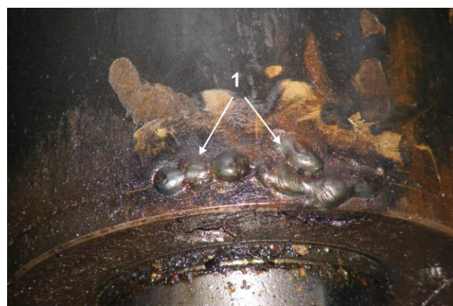
Rys. 8 Niska jakość połączeń spawanych (1)
