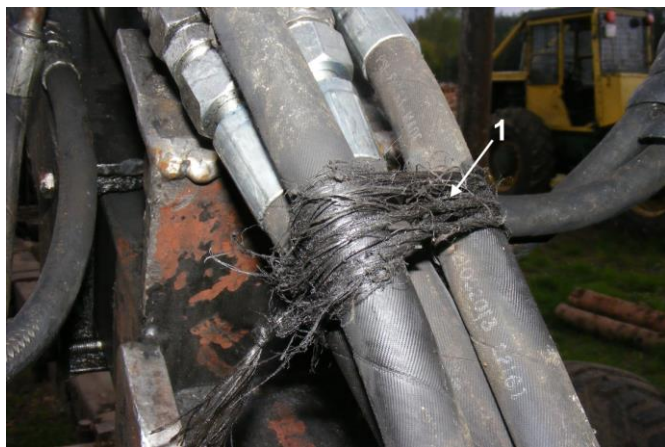
Rys. 10. Doraźnie wykonane „pozycjonowanie” wiązki przewodów hydraulicznych
