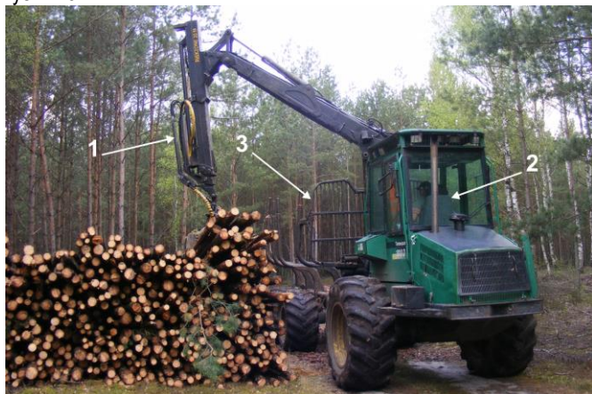
Rys. 1. Pojazd typu forwarder 6x6 przeznaczony do transportu drewna: 1 – dźwиг hydrauliczny, 2 - kabina kierowcy-operatora, 3 – skrzynia ładunkowa
