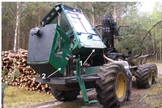
Rys. 11. Dostęp do układów i zespołów forwardera: 1 – odchylana kabina, 2 – podnoszona obudowa silnika
